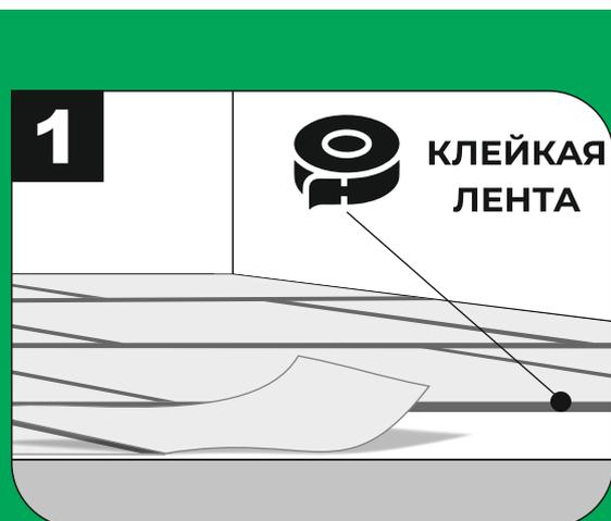
**7.1** Для компенсации неровностей основания и обеспечения комфорта при эксплуатации расстилается плотная подложка толщиной 1,5 мм с плотностью от 60 кг/м<sup>3</sup>, рекомендованная для укладки под SPC-покрытия. Подложка укладывается встык и закрепляется при помощи клейкой ленты по всей длине стыка.
