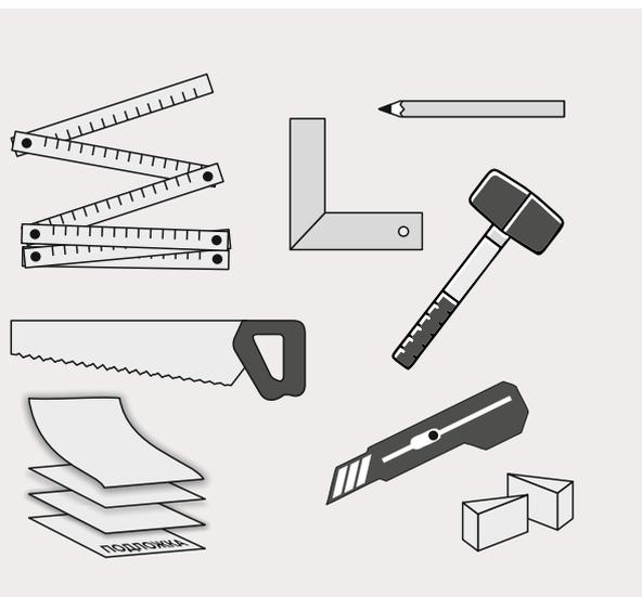
**6.1** Для укладки SPC-покрытия высокой плотности (кварцевого ламината Home Expert) потребуются линейка, карандаш, пила (или электролобзик), угольник, распорные клинья, нож, резиновая киянка, плотная подложка толщиной 1,5 мм.
